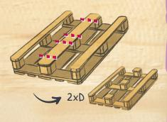
Bei zwei weiteren Paletten nur die beiden unteren Mittelstücke heraussägen.
