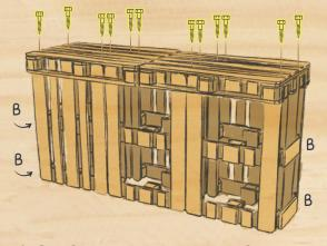
7. ZUR STABILISIERUNG SCHRAUBEN SIE DIE VIER BRETTER B AUS SCHRITT 1 AN BEIDE SEITEN.
