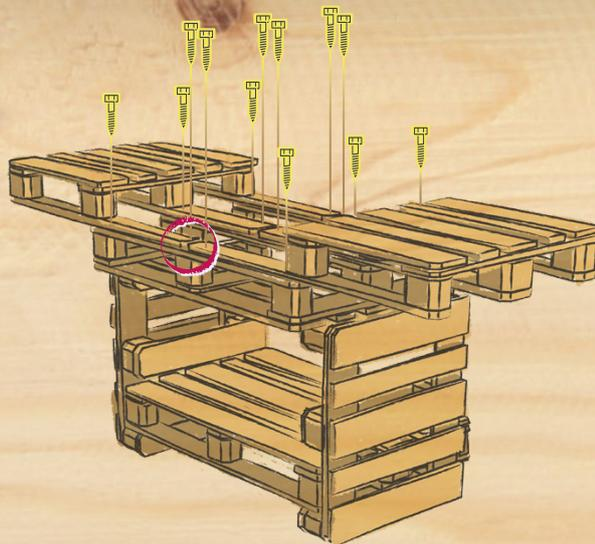
5. DIE BEIDEN PALETTEN AUS SCHRITT 4 MITTIG AUF STOSS PLATZIEREN UND FESTSCHRAUBEN.
