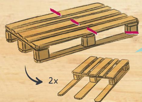
4. ZWEI PALETTEN AN DER OBEREN ROTEN LINIE ZERSÄGEN UND DIE BRETTER SAMT KLÖTZE ENTFERNEN.
