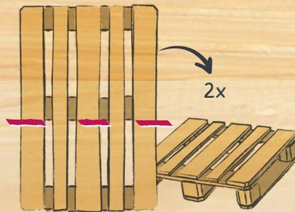
1. FÜR DIE SEITENTEILE ZWEI PALETTEN AN DER ROTEN MARKIERUNG ZERSÄGEN.
