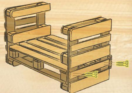
2. DIE SEITENTEILE HOCHKANT HINSTELLEN. ALS UNTEREN BODEN EINE PALETTE ZWISCHEN DIE PALETTEN LEGEN, ANSCHLIESSEND BÜNDIG MIT DER VORDERKANTE AUSRICHTEN UND VERSCHRAUBEN.
