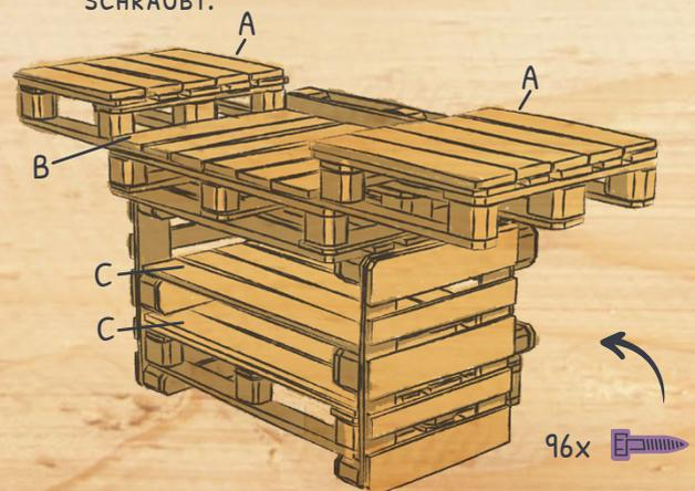
8. ALS LETZTEN SCHRITT LEGEN SIE DIE TERRASSENDIELENZUSCHNITTE AUF, BOHREN DIESE VOR UND VERSCHRAUBEN SIE ANSCHLIEßEND. FERTIG.
