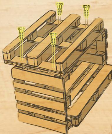
3. EINE UMGEDREHTE PALETTE BÜNDIG MIT DER RÜCKSEITE NACH UNTEN AUF DEN SEITENTEILEN PLATZIEREN UND MITEINANDER VERSCHRAUBEN.
